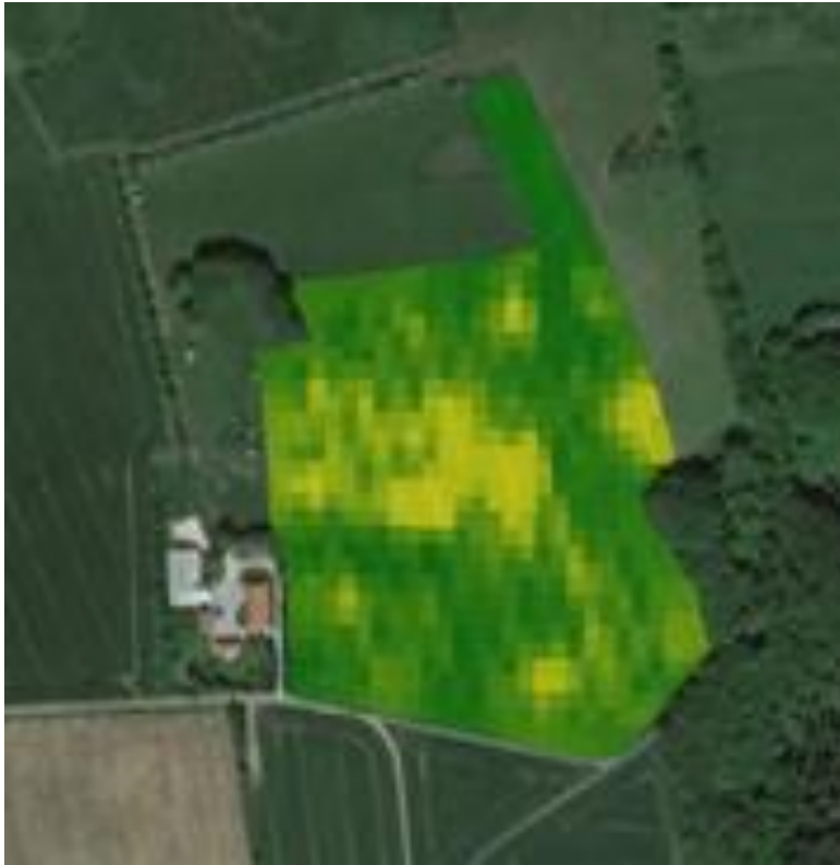
Figur 6. I CropSAT ser NDVI beregningen ud som vist her. Det betyder, at data går helt ud til markkanten på grund af ekstrapolation fra naboceller.
