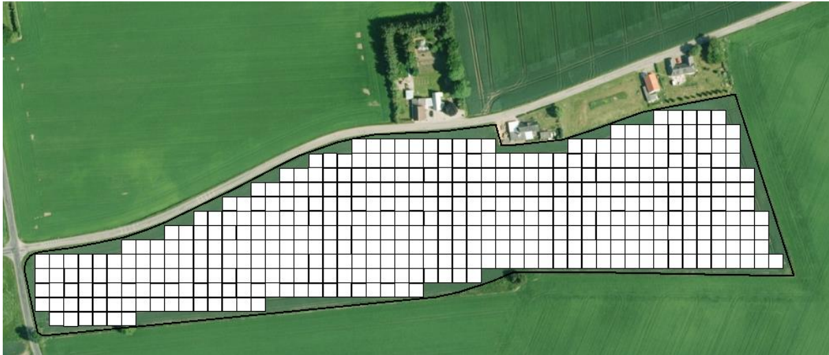
Figur 5. Alle pixels der ligger på markkanten er fjernet i datasættet inden NDVI beregningen foretages.
